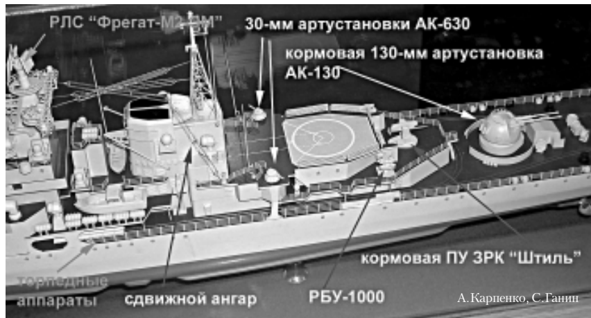
Кормовая часть модели «стандартного» эсминца пр. 956
